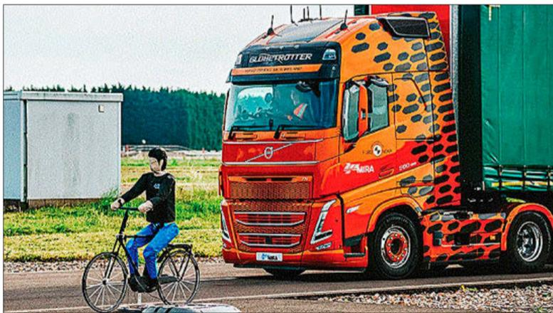
Prueba del sistema de frenada de emergencia que evita atropellos. EURONCAP
